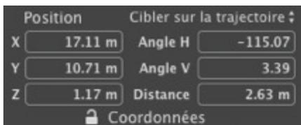
La caméra se déplace tangentiellement à la trajectoire. Les angles horizontaux et verticaux peuvent être définis par rapport à cette tangente. Le champ distance fournit la distance entre la caméra et le point de visée.
